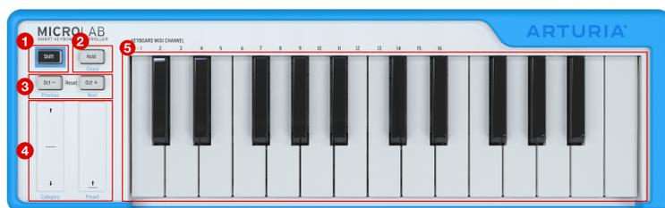
1. Кнопка Shift: эта кнопка позволяет получить доступ ко второстепенным функциям MicroLab. Дополнительные функции перечислены синим цветом текста под кнопками и полосами и черным цветом над первыми 16 клавишами клавиатуры.
